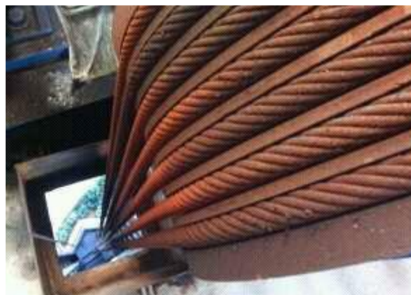
Figure 3 : Câble de traction
