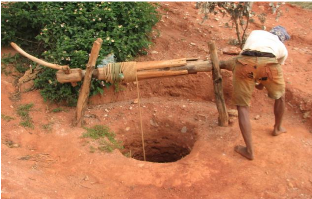
Photo 8:Puits d'une petite mine souterraine avec palan
