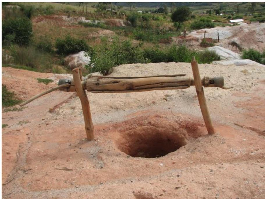
*Photo 6 : Puits et palan utilisé dans la technique d'exploitation traditionnelle*
